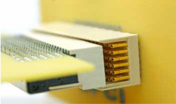
Smiths Interconnect의 견고한 2mm cPCI 시리즈는 높은 신뢰성을 갖춘 커넥터 솔루션에 대한 시장의 요구에 응답함으로써 Compact PCI 사양의 기계적 풋프린트와 전기적 성능을 충족시킵니다. 내구성과 고속 성능에 최적화된 cPCI 커넥터는 우수한 Hypertac 하이퍼볼로이드 접합 기술을 활용합니다. 백플레인의 0.4mm Hypertac 단자는 1A의 정격 전류뿐만 아니라 8 m 미만의 접촉 저항으로 최대 3.125Gbps의 데이터 속도 성능을 제공합니다. 이는 최적화된 리드 트레이스와 결합하여 고속 신호 애플리케이션에서 뛰어난 성능을 제공합니다.
